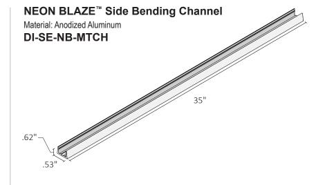
SIDE BENDING STRIP LIGHT SPECIFICATION SHEET
